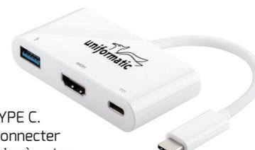
Permet de connecter un écran équipé d'un port HDMI sur un PC équipé d'un port TYPE C. Le port USB 3.0 permet de connecter un périphérique supplémentaire à votre ordinateur comme les claviers, souris, clefs USB. Le port TYPE C apporte l'alimentation pour les périphériques gourmands en énergie (disques durs externes).
