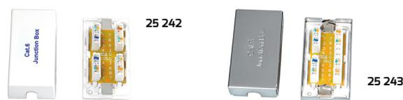
Boîtier de jonction CAT6 permettant de raccorder 2 câbles réseau entre eux. S'utilise exclusivement avec du câble monobrin non monté (sans aucun connecteur 8P8C/RJ45 ou autre). Contacts auto-dénudants, connexion avec outil d'insertion. Fixation murale par vis ou adhésif double face.
