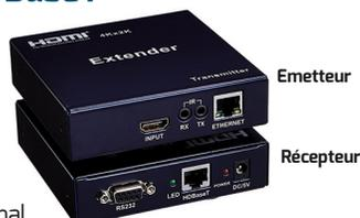
Basé sur le protocole normalisé HD BaseT (IEEE 802.1Q), cet extenseur permet de déporter un signal audio/vidéo HDMI en même temps qu'un signal Ethernet et Série RS232. La distance peut aller jusqu'à 70m pour une source en 4K et jusqu'à 100m pour une source en Full HD via un cordon RJ45. La référence 73 192 comprend un couple Emetteur + Récepteur. Livré avec les alimentations 5V.
