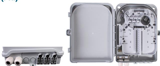
Conçu pour gérer et connecter 12 ou 24 fibres. Les accès au lovage des fibres ou au jarretière peuvent être verrouillés de manière indépendante. Étanchéité du boîtier : IP65
