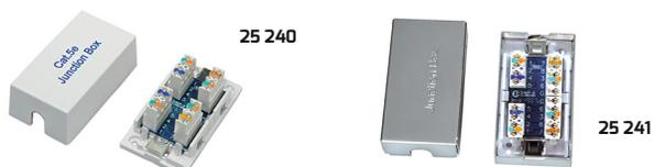
Boîtier de jonction CAT5e permettant de raccorder 2 câbles réseau entre eux. S'utilise exclusivement avec du câble monobrin non monté (sans aucun connecteur 8P8C/RJ45 ou autre). Contacts auto-dénudants, connexion avec outil d'insertion. Fixation murale par vis ou adhésif double face.
