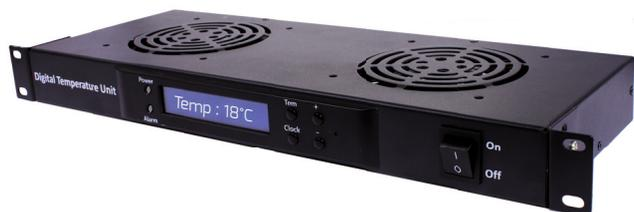
Permet de réguler la température interne de vos baies en assurant une circulation forcée de l'air, évitant ainsi une surchauffe du matériel. Le ventilateur rackable s'intègre dans tout type de baie et coffret 19" et prend l'emplacement d'1U. Le thermostat permet de personnaliser la température intérieure de la baie ou du coffret (plage de température : +17°C à +23°C par exemple). La fonction alarme avertit en cas de forte hausse ou de forte baisse de température.
