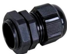
Assure le passage d'un câble Fibre optique au travers de votre boîtier vers l'extérieur. Il assure l'étanchéité vis-à-vis des corps étrangers, de la poussière, de l'eau etc. Il permet surtout le blocage du câble pour éviter les arrachages intempestifs.
