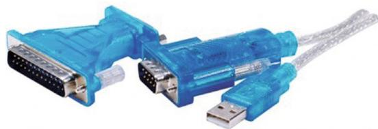
Ce convertisseur vous permet de connecter un périphérique série type RS232 (balance, scanner, douchette code barre, capteur divers...) sur un port USB de votre ordinateur. Equipé d'un câble de 1 mètre et d'un adaptateur DB25-DB9 il s'adapte à n'importe quel périphérique.
