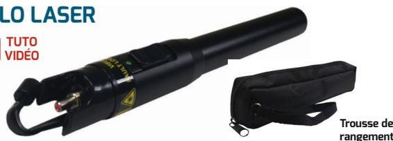
Ce stylo Laser permet de vérifier la continuité de la fibre dans le cadre d'un diagnostic sur une liaison déjà installée, d'identifier les cassures, repérer une fibre dans un faisceau de fibre ou de s'assurer du bon fonctionnement d'un lien optique avant son installation. Livré avec : trousse de rangement, adaptateur LC et notice d'utilisation. Fonctionne avec 2 piles AA non fournies.
