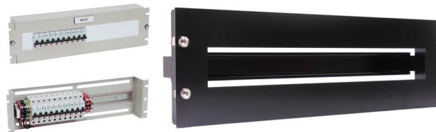
Boîtier standard 19" pour héberger un dispositif modulaire. Equipé d'un rail Din et d'un logement avec ouverture de 402.5x45.5mm. Profondeur : 60mm
