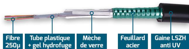
Fibre dotée d'une très haute protection contre les rongeurs. Possibilité d'enfouissement direct dans un environnement peu humide. Sa grande rigidité lui assure un bon maintien pour une installation facilitée sous fourreaux.
