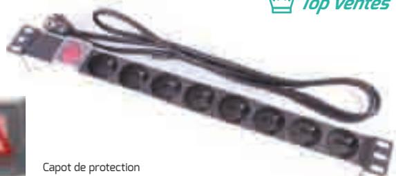
Dispose de pattes 19" réglables permettant de décaisser les prises. Elles sont positionnables par rotation de 45°. Boîtier en Aluminium. Dispose d'un capot de protection posé sur l'interrupteur afin d'éviter les coupures maladroites et non souhaitées. Le voyant rouge permet de savoir si les prises sont alimentées ou non.
