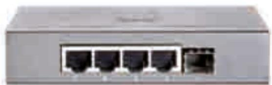
Ce switch Ethernet dispose en plus de leur port RJ45 cuivre d'un emplacement SFP pouvant recevoir un mini GBIC afin d'apporter un lien fibre optique.
