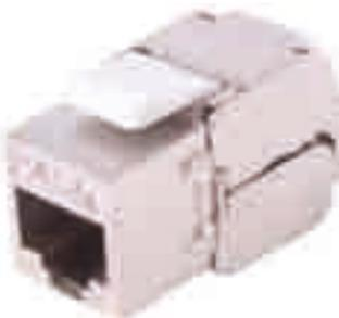
Destinée à la fois à être utilisée au niveau du panneau de brassage et dans tous les supports au poste de travail. Simple et rapide, ce connecteur se monte sans outil. Modèle professionnel : qualité supérieure. Catégorie 6A pour les débits jusqu'à 10 Gbps. Embase autodénudante.
