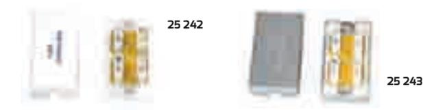
Boitier de jonction CAT6 permettant de raccorder 2 câbles réseau entre eux. S'utilise exclusivement avec du câble monobrin non monté (sans aucun connecteur 8P8C/RJ45 ou autre). Contacts auto-dénudants, connexion avec outil d'insertion page 19. Fixation murale par vis ou adhésif double face.
