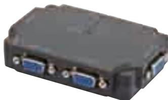
Splitter entrée de gamme. Permet de dupliquer l'affichage d'une même source vidéo vers 2 ou 4 écrans (selon modèle). Idéal pour les écrans jusqu'à 19 pouces
