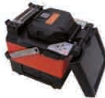
La soudeuse optique est l'outil de production qui va permettre au raccordeur fibre optique d'effectuer la fusion de ses fibres.
