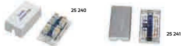
Boitier de jonction CAT5 permettant de raccorder 2 câbles réseau entre eux. S'utilise exclusivement avec du câble monobrin non monté (sans aucun connecteur 8P8C/RJ45 ou autre). Contacts auto-dénudants, connexion avec outil d'insertion page 19. Fixation murale par vis ou adhésif double face.
