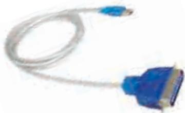
Ce convertisseur vous permet de connecter une imprimante parallèle (prise Centronics 36) sur le port USB d'un PC.
